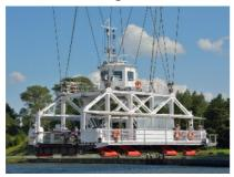
konstruktion, weist immerhin noch eine Länge von 2.486 m auf, und die eigentliche (Haupt-) Brücke hat eine Gesamtlänge von 317 m, eine Stützweite von 140 m und garantiert dem Schiffsverkehr eine lichte Höhe von 42 m. Aber der Clou ist die *Schwebefähre*, die mit Drahtseilen an der Brücke hängt und Fußgänger, Radfahrer und pro Fahrt auch bis zu sechs Autos zum anderen Ufer bringt (Foto: Nightflyer).
